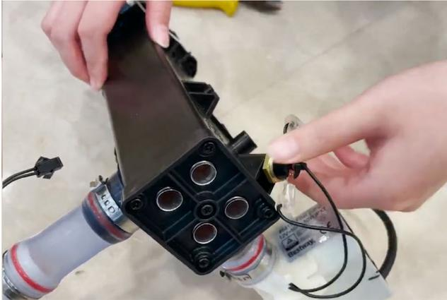
17. Installez le NOUVEL écrou-fil noir-connecteur rouge (capteur de température) et le NOUVEAU connecteur noir-écrou doré (capteur de coupure thermique) ; seul le NOUVEL écrou-fil noir-connecteur rouge (capteur de température) devra être ajusté également à l'aide d'une pince.
