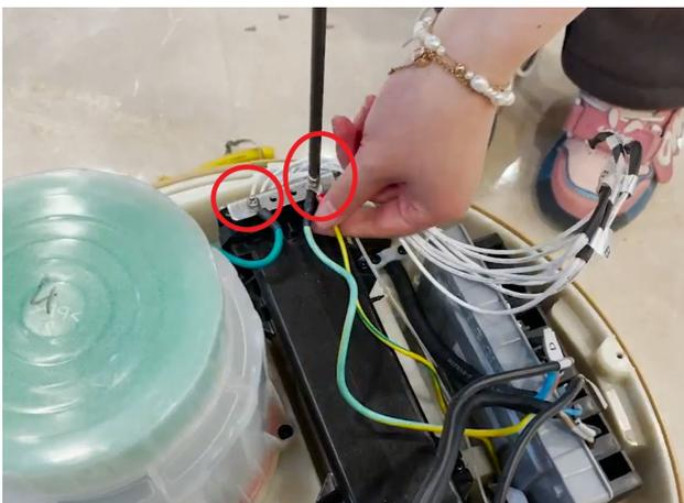
11. Débranchez le câble noir en appuyant sur la languette du connecteur femelle et en tirant sur le connecteur mâle ; faites de même avec le connecteur blanc à fils multiples et le connecteur rouge à fil unique.
