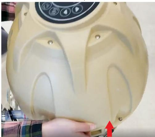
3. Détachez la ligne de signal pour séparer le couvercle supérieur du corps de l'appareil.
