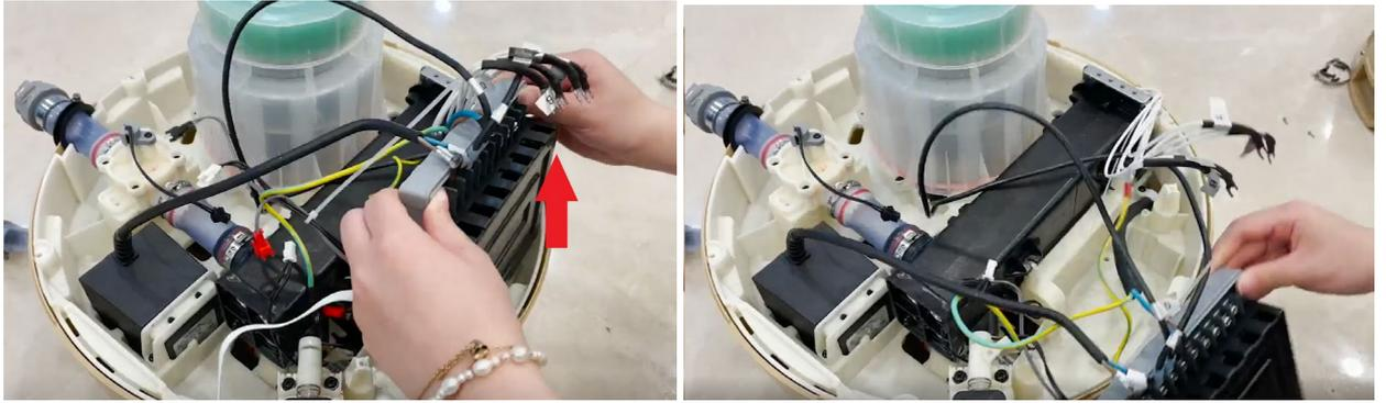
15. Retirez la résistance chauffante et les tuyaux en une seule pièce en les soulevant ; les mettre de côté.
