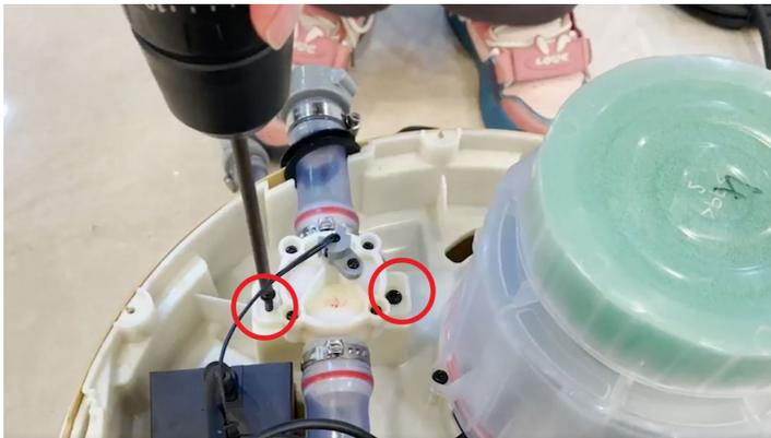
14. Retirez la carte électronique en la tirant vers le haut ; laissez-la pendre d'un côté de la pompe.
