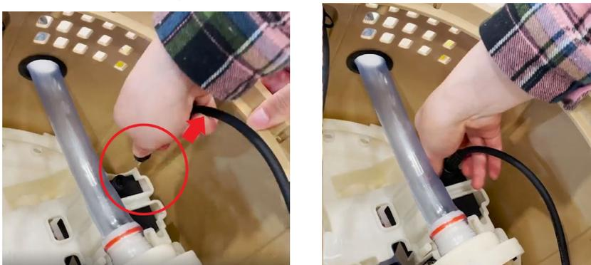
27. Reconnectez le tuyau à la pompe à eau en le pressant sur le joint coloré, puis ajustez le clip de sécurité métallique autour du tuyau à l'aide d'une vis.
