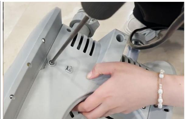
25. Retournez à nouveau cette partie, avec le couvercle de base fixé, puis fixez la ligne de signal du panneau de contrôle au corps de l'appareil.
