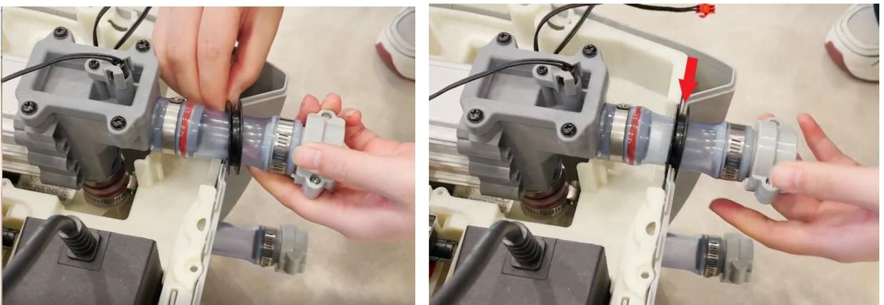
16. Fixez les deux blocs de sécurité sur l'élément chauffant PTC à l'aide de leurs vis.
