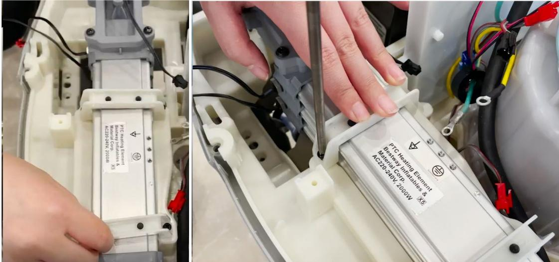
17. Reconnectez et vissez les fils blancs supérieur et inférieur de la résistance chauffante à la carte électronique (supérieur : première et deuxième position/ inférieur : troisième et quatrième).
