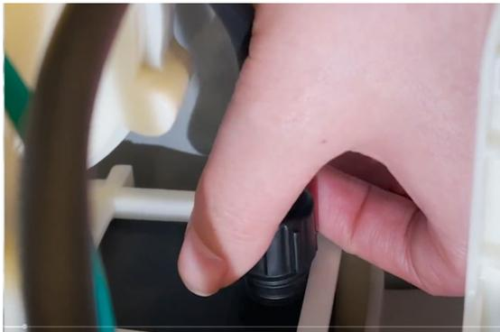
23. Fixez le joint noir inférieur dans le corps de l'appareil, pour maintenir le tuyau.
