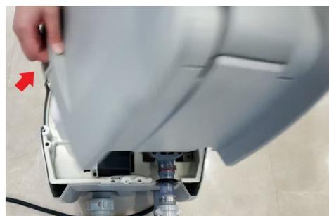
4. Détachez la ligne de signal pour séparer le couvercle supérieur du corps de l'appareil.
