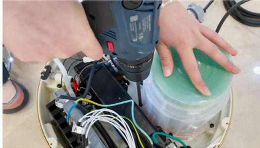
10. Vissez les câbles "D" dans le circuit imprimé.
