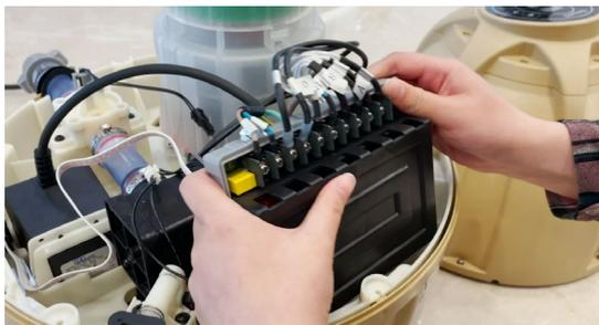
5. Dévissez les 2 câbles à partir du côté gauche de la carte de circuit imprimé (D, D).
