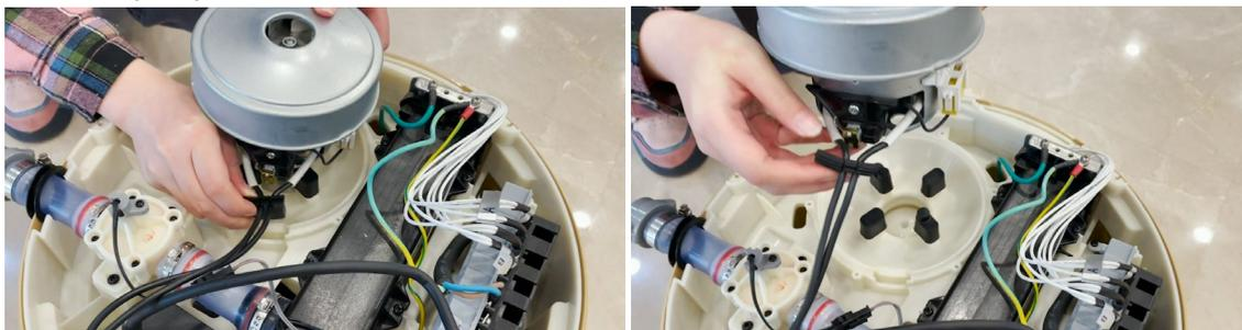
8. Remplacez la pompe à air en place, en veillant à insérer la partie en caoutchouc noir dans la prise.
