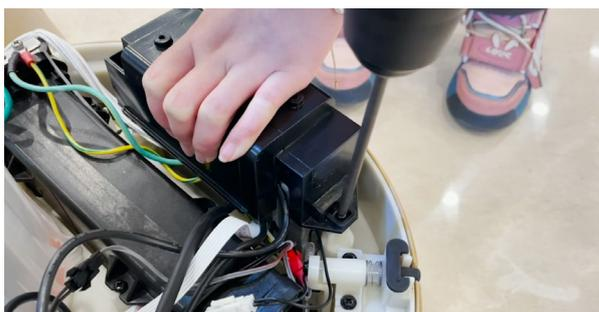
12. Reconnectez la ligne de signal du panneau de contrôle au corps de l'appareil.
