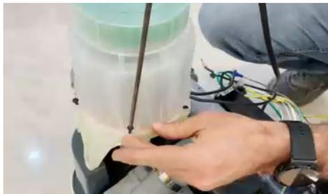
9. Remettez la carte électronique en place et vissez le câble dans les 3e et 4e vis du côté gauche de la carte électronique.
