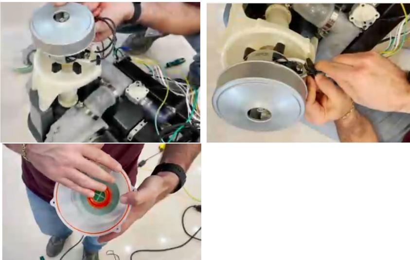
8. Remettez le couvercle sur le dessus de la pompe à air et revissez les 6 vis.
