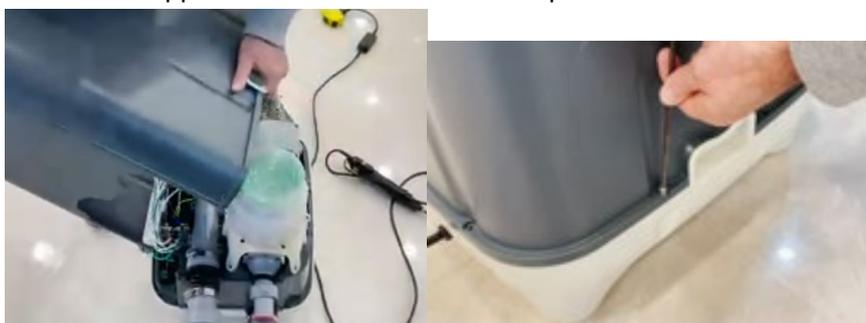
3. Détachez la ligne de signal du panneau de contrôle pour séparer le couvercle supérieur du corps de l'appareil.
