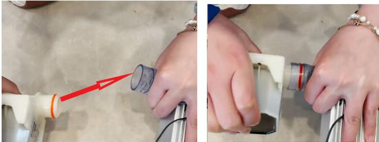
16. Ajustez les connexions des deux tuyaux à l'aide de clips métalliques.
