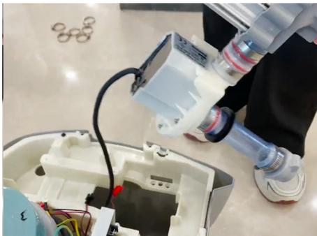
13. Retirez les deux clips métalliques (des tuyaux connectés à la pompe à eau) en tirant sur un côté à l'aide d'une pince.
