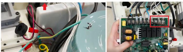
11. Dévissez les 2 vis de la partie en plastique blanc fixant la résistance chauffante et retirez-la, puis retirez la résistance chauffante.
