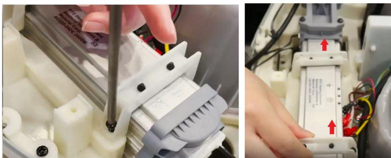
12. Séparez le couvercle gris (côté des fils blancs) de la résistance chauffante en dévissant les vis (6) et en le tirant vers le haut.
