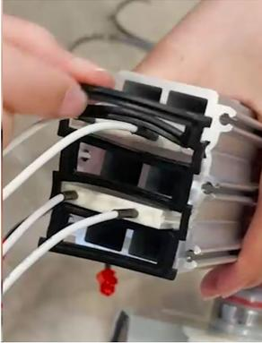
14. Dévissez la pièce de fixation grise de l'autre côté en retirant les vis (6) et retirez la résistance chauffante en le tirant.
