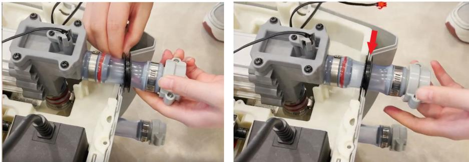
21. Fixez les deux blocs de sécurité sur la résistance chauffante avec leurs vis.
