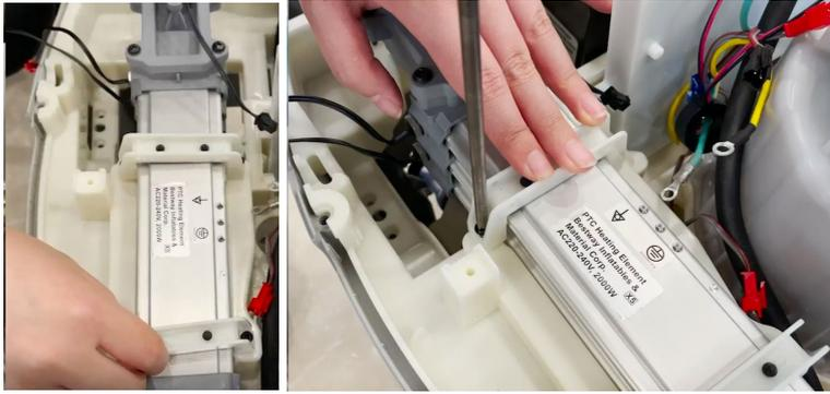
22. Reconnectez et vissez la connexion de la résistance chauffante sous les 4 premières vis du côté droit de la carte électronique.
