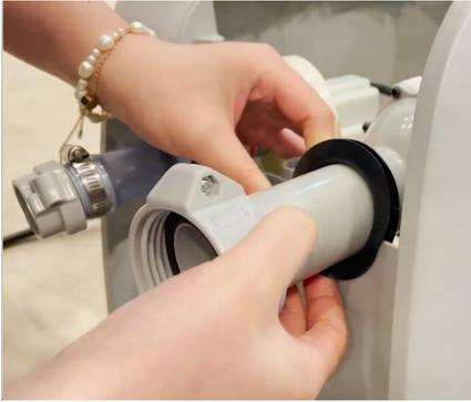
30. Remettez le couvercle de la base dans la partie supérieure de la pompe du spa (c'est la base du couvercle puisqu'il est retourné) et fixez-le avec ses vis (6 pièces).
