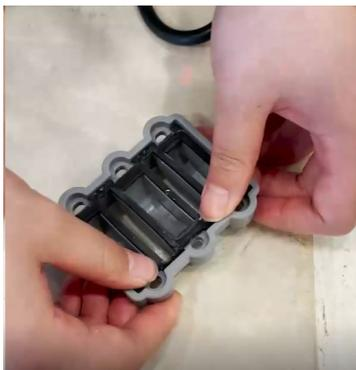
17. Prenez la NOUVELLE RÉSISTANCE CHAUFFANTE et positionnez-la avec l'étiquette vers le haut ; localisez maintenant les deux fils supérieurs blancs et passez-les à travers les deux trous supérieurs de la pièce grise dans l'étape ci-dessus ; répétez la même chose pour les deux autres fils inférieurs ; puis déplacez la pièce grise vers la résistanc chauffante et fixez-la en vissant les vis (6).
