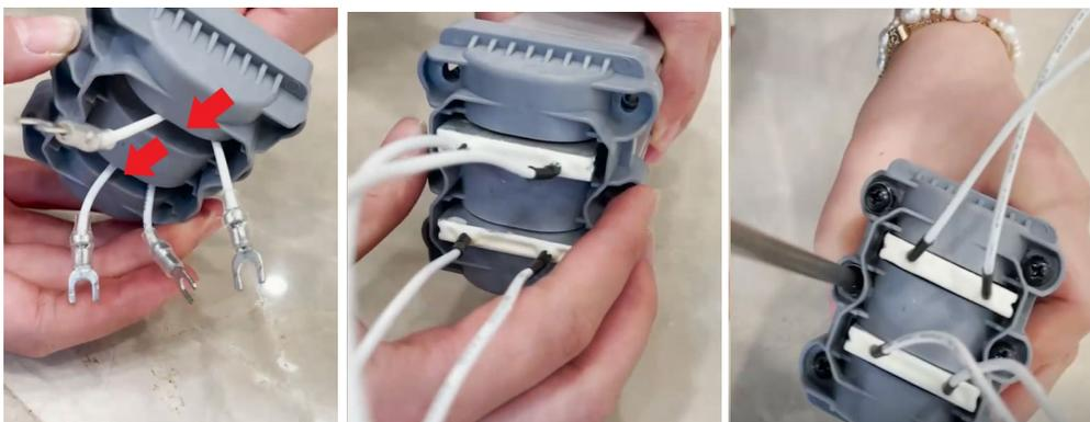
18. Remettez l'autre joint noir dans la pièce grise qui est restée attachée au tuyau de la pompe à eau ; prenez ensuite la NOUVELLE RÉSISTANCE CHAUFFANTE - côté libre - et mettez-la en place ; fixez-la à l'aide des vis (6).
