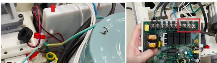
11. Dévissez les 2 vis de la partie en plastique blanc fixant la résistance chauffante et retirez-les, puis retirez la résistance chauffante.
