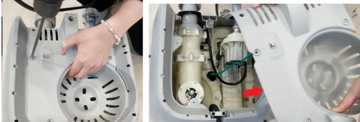
6. Débranchez manuellement le XXXXX en le dévissant avec deux doigts (pouce et index) et en tirant la partie supérieure vers le haut.
