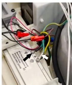
27. Remettez en place la partie en plastique blanc, pour couvrir la carte électronique et la fixer à la structure (2 vis).
