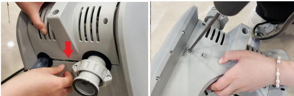
31. Attachez la ligne de signal du panneau de contrôle au corps du réchauffeur et remettez le couvercle en place.
