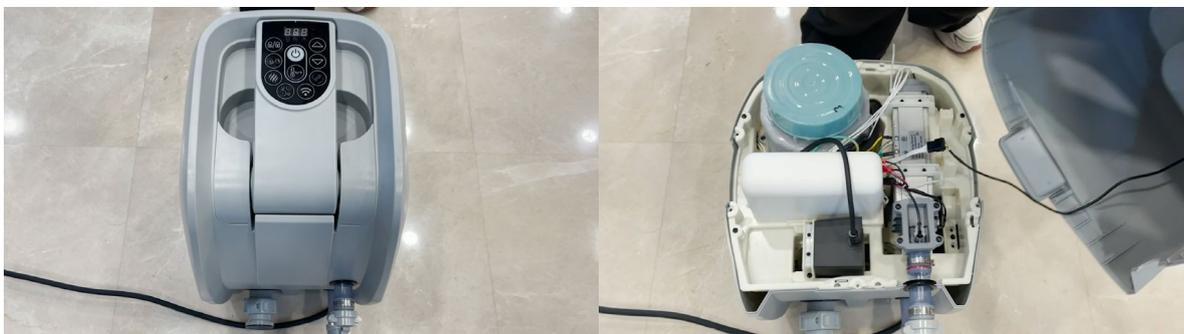
3. Détachez la ligne de signal du panneau de commande pour séparer le couvercle supérieur du corps de la pompe.
