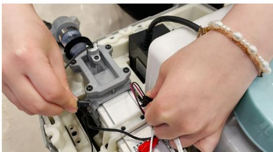
5. Dévissez les vis de la boîte en plastique et retirez le capteur de débit d'eau.
