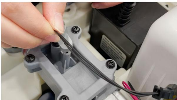
6. Remplacez le capteur de débit d'eau en l'insérant dans le trou et en le revissant.
