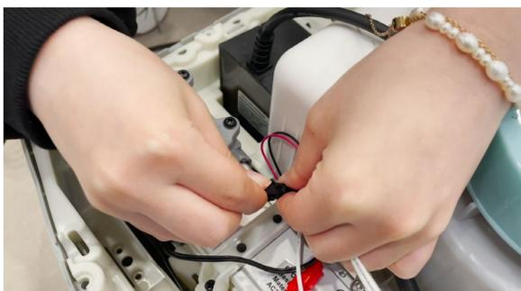
8. Fixez la ligne de signal du panneau de contrôle au corps de la pompe et remettez le couvercle supérieur en place.
