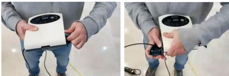
7. Insérez le câble du panneau de contrôle dans le trou situé sur le côté droit du couvercle supérieur.
