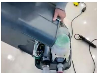
3. Détachez la ligne de signal pour séparer le couvercle supérieur du corps de l'appareil.
