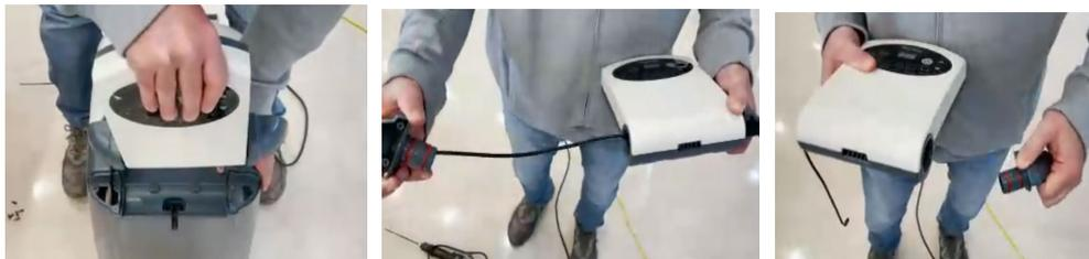
6. Fixez les 2 supports latéraux (parties latérales) au nouveau panneau de contrôle. Veillez à ce que le câble du panneau de contrôle soit inséré dans le trou.
