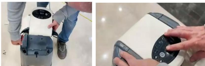
8. Retournez le couvercle supérieur et revissez les 6 vis, puis rattachiez la ligne de signal au corps de la pompe.
