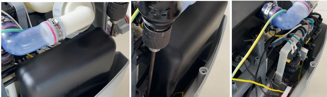
6. Dévissez les 5e et 6e vis du côté gauche de la carte électronique et détachez les câbles noirs (pompe à air).
