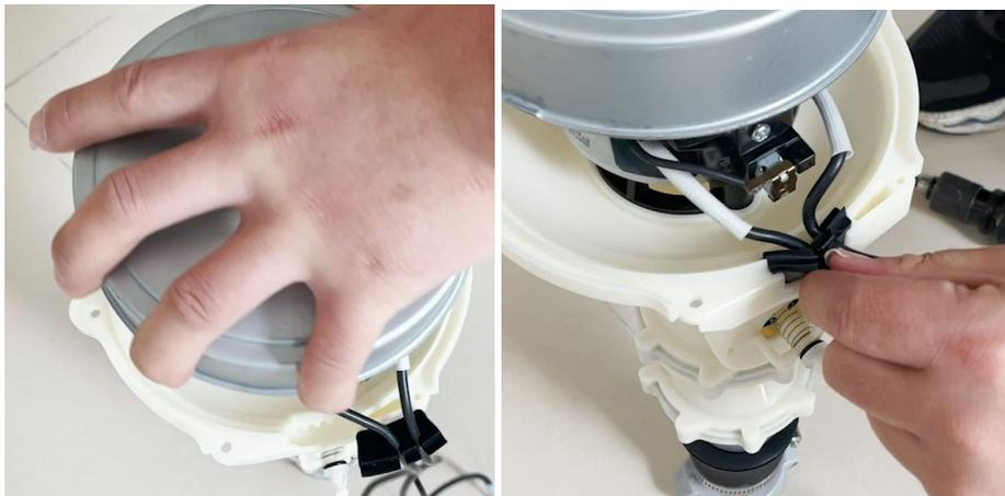
12. Remettez le couvercle sur la pompe à air et revissez les vis sur le couvercle en plastique gris.
