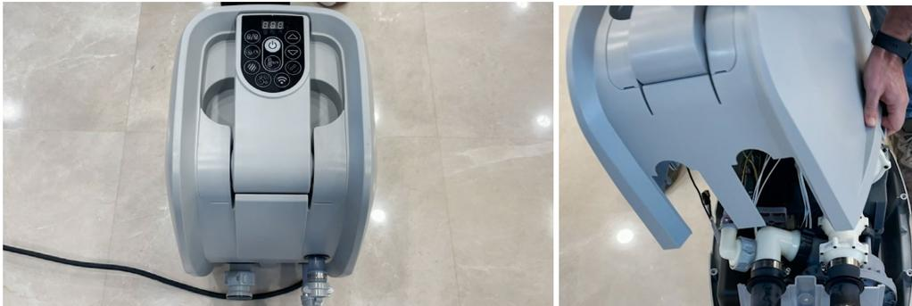
4. Détachez la ligne de signal du panneau de contrôle pour séparer le couvercle supérieur du corps de l'appareil.
